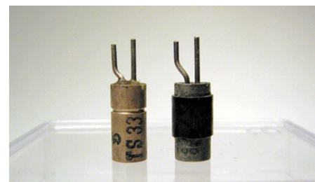
Siemens-Punktkontakt-Transistor TS33 (li) und Bell-Transistor Typ 1768 (re)
