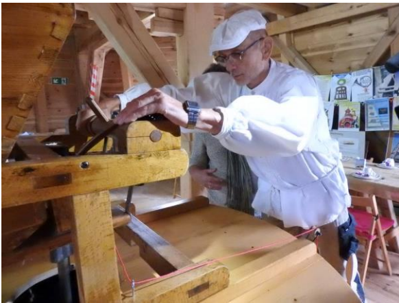
Der Rüttelschuh wird so eingestellt, dass genug Getreide zwischen die Mahlsteine kommt.
