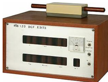
Bild 7: Funkuhrempfänger nach Hilberg von 1973 6
