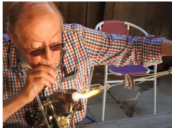
Das Rohrende über dem Kelch wird zu einer Kugel aufgeblasen, bis sie platzt. Dann kann das verbliebene Rohrende abgetrennt werden.
