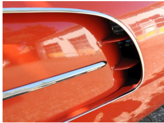
Seitliche Lufteinlässe führen die nötige Kühlluft zu.
