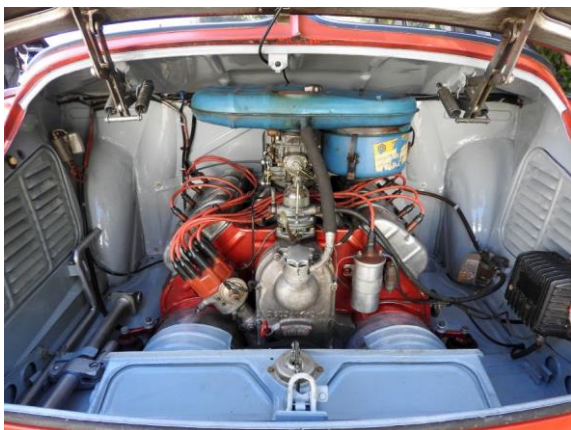
Die Leistung des 8-Zylinder-V-Motors wurde beim 603-3 auf 105 PS gesteigert. Zwei Fallstromvergaser versorgen die 8 Zylinder, die Kühlung sichern zwei über Keilriemen angetriebene Axialgebläse.
