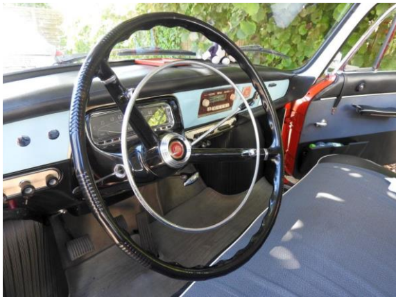
Der Fahrer Arbeitsplatz: großes Lenkrad mit Hup-Ring, keine Servolenkung, Lenkradschaltung (synchronisiertes 4-Gang-Getriebe), durchgehende Sitzbank, viel Platz und viel Chrom.
