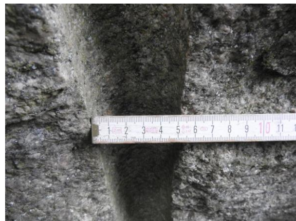
Die Bohrungen im Großen Stein von Neuendorf Stein haben einen Durchmesser von 50 mm und erreichen eine Tiefe von bis zu 2,90 m.
