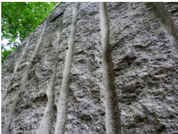
Die Bohrungen wurden sehr tief in den Stein eingebracht, wodurch eine ebene Spaltfläche erzielt wurde.
