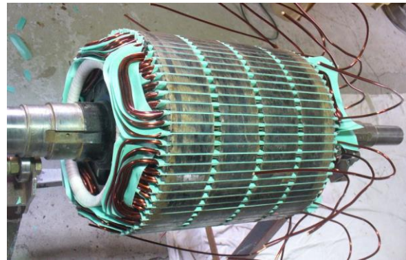
Dieser E-Motor stammt aus der Greiffenberger Motormühle, die in den 30er Jahren in Konkurrenz zur Erdholländermühle gebaut wurde. Durch PCK und EAB wurde er komplett restauriert und dient heute als Antrieb für den Mahlgang. 2
