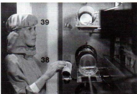
Bild 14: Diffusionsanlage für 100-mm-Scheiben
