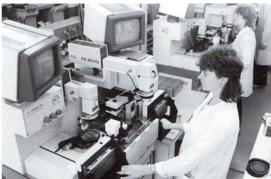
Bild 17: Vollautomatischer Chipbonder VACB 01
