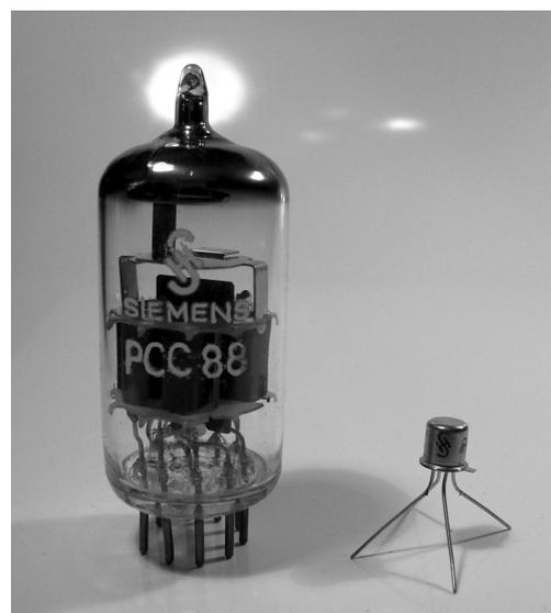
*Bild 7: Gegenüberstellung von Siemens-Röhre PCC88 und Siemens-MESA-Transistor AF139. Die Röhre PCC88 war speziell für UHF-Vorstufen entwickelt worden. Damit wurde ein Rauschfaktor von etwa 12 dB erreicht. Durch den Einsatz des AF139 konnte der Rauschfaktor ganz erheblich auf 7 bis 9 dB verbessert werden.*
