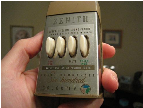
Die Fernbedienung „Space Control“ von Zenith funktionierte ohne Batterie und erzeugte Ultraschalltöne zur Steuerung des Fernsehers. 5
