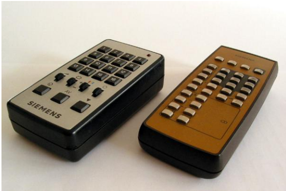
Zwei Fernbedienungs-Generationen von Siemens: Links eine Ultraschall-Fernbedienung, rechts die Infrarot-Fernbedienung FB84.
