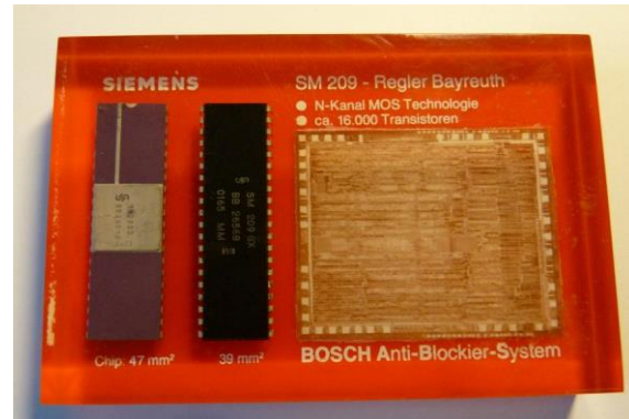
Der SM209 war ein ABS-Steuerschaltkreis in N-Kanal-MOS-Technologie. Er wurde ab 1983 bei Siemens HL für Bosch hergestellt. (Foto: K. D. Bigall)
